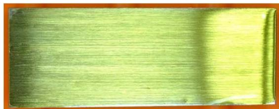
Prueba con la solución Ferroxyll aplicada a una de las superficies. Después de 4 minutos de prueba, no hay indicaciones de partículas de óxido de hierro ni de hierro.
